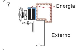
7 Encoste a placa de atraque com o suporte Z na fechadura, para que colem uma à outra. Encoste o Z do suporte na folha da porta.
