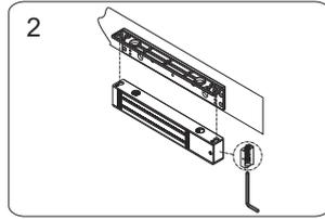
2 Parafuse o eletroímã do suporte L utilizando os parafusos de fixação.
